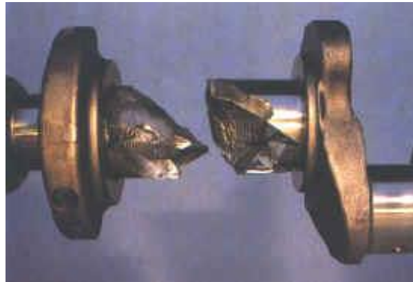
شکل ۱: شکست میل لنگ در اثر ارتعاشات پیچشی
